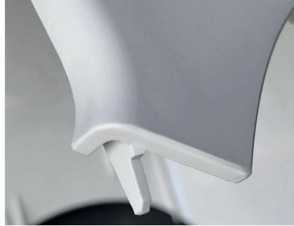
**Reinigung spart Zeit und Geld und senkt die Ausschussquote:** Den positiven Effekt der Formreinigung mittels Lusin MC1718 macht der Vorher-Nachher-Vergleich des entnommenen Thermoplast-Bauteils deutlich © Chem-Trend
